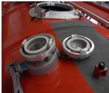
Der obere Luftanschluss wird mit Wasser gereinigt
