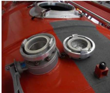
Der obere Luftanschluss wird mit Wasser gereinigt
