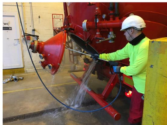
E78 Hochdruckreinigung der Befüll- und Entladeöffnungen, Fugen, Deckel und allen verbundenen Bauteilen
