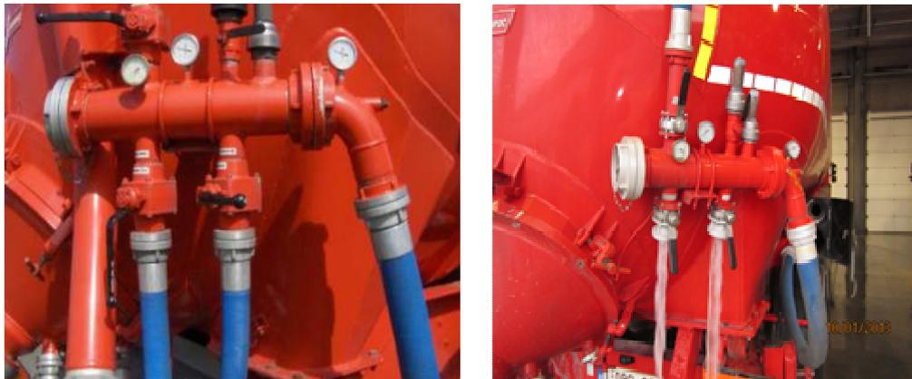
Der Mikrofilter wird mit Luft und das Filtergehäuse innen wird mit Wasser gereinigt
